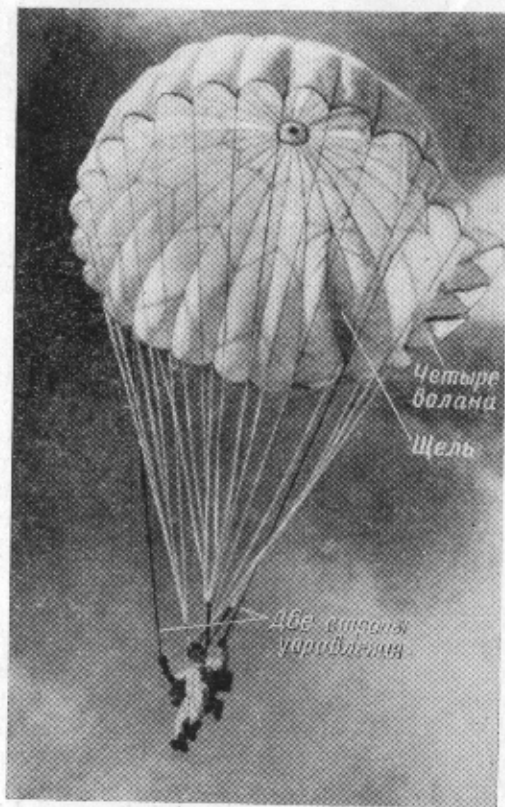
Рис. 46. Американский парашют с круглым куполом из нейлона с щелевыми отверстиями и четырьмя воланами на нижней кромке купола, служащими для управления парашютом при спуске
